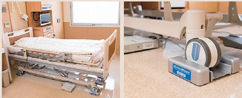
ベッドの脚に設置したセンサーで変化を検知
