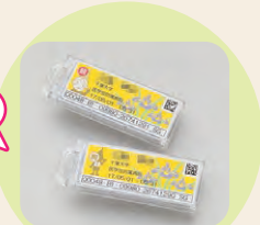
個人被ばく線量計 放射線を扱う技師や医師が着用する個人被ばく線量を測定するバッジ
