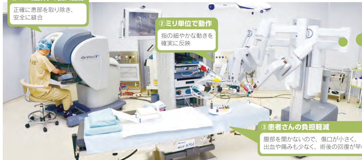
医師が拡大された立体画像を見ながら(写真左)、ロボットアーム(写真右)を操作します
